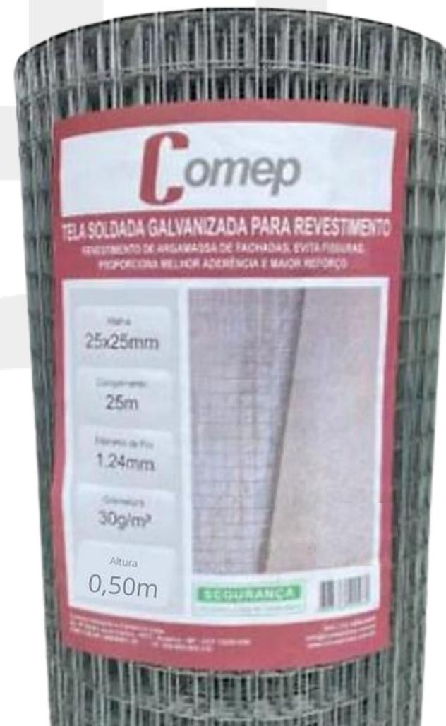
A tela para revestimento Comep tem como finalidade a prevenção do surgimento de fissuras no revestimento de fachadas. Indicada para suportar tensões provenientes da dilatação e retração do revestimento de argamassa, evitando o surgimento de trincas, distribuindo assim, as tensões ao longo do revestimento.
